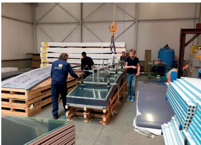
Productie van de cassettes in de fabriek in Zevenbergschen Hoek. De onderste polycarbonaat plaat - met de kunststof profielen (afstandhouders) - wordt op de voorgevormde werktafel gelegd.
